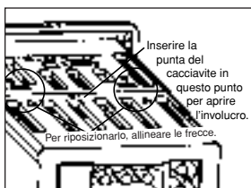
Figura 1 — Scanalatura per il cacciavite e frecce di allineamento per il montaggio
